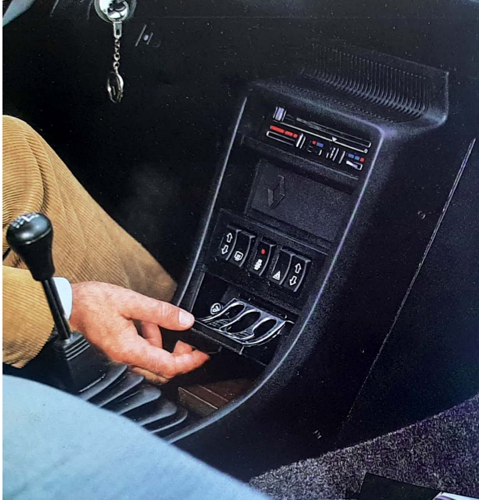
Consola con preequipo de radio, mandos de elevalunas y cierre de puertas.
