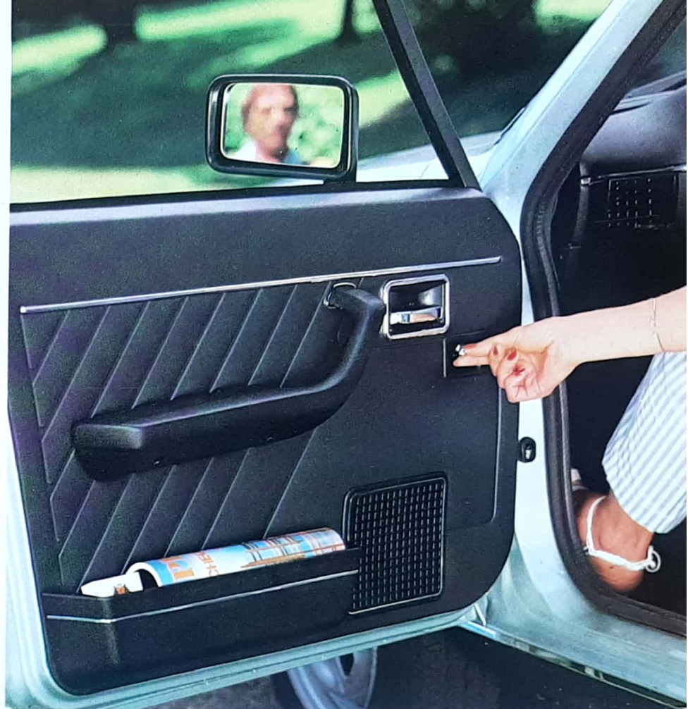
Panel de puerta con preinstalación de altavoz incorporado. Espejo exterior regulable desde el interior.
