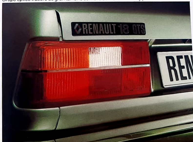
Grupo óptico trasero de gran tamaño con faro de marcha atrás y piloto antiniebla.
