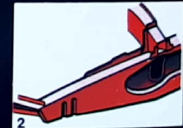
2.—Travesaño de chasis provisto de puntos deformables. Concebidos para la absorción controlada de energía.
