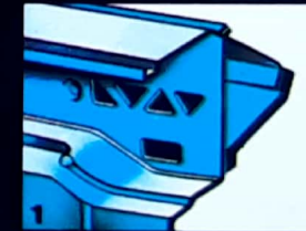
1.—Travesaño inferior del parabrisas, reforzado.
