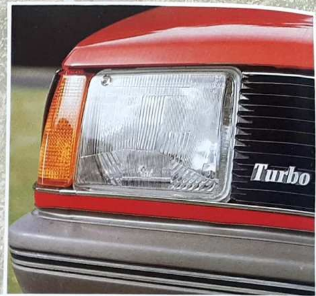
Faros equipados con lámparas halógenas.
