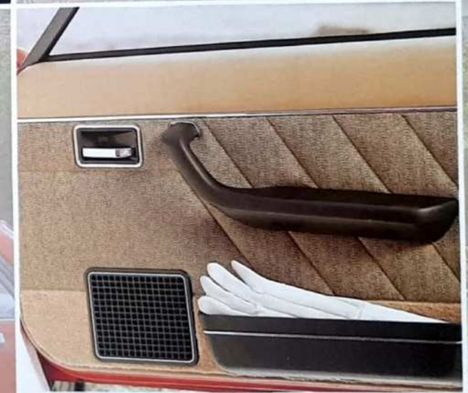
Puertas guarnecidas, con instalación para altavoces.
