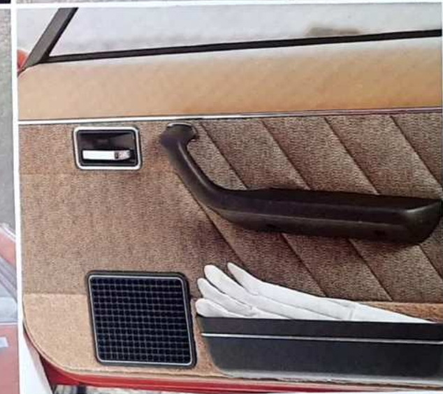
Puertas guarnecidas, con instalación para altavoces.
