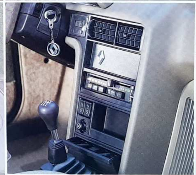
Versión aire acond. Consola con controles de climatización, mandos elevavinas y reloj de cuarzo.
